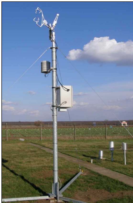
2. kép. CSAT3 típusú szónikus anemométer, valamint LI7500 típusú H_2O , CO_2 -koncentráció mérő berendezés a 4 méteres mérőtornyon a szenzibilis és latens hőáram eddy kovariancia módszerrel történő meghatározásához
