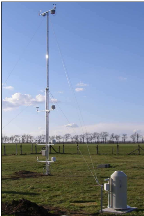
1. kép. A 10 méteres mérőtorny a léghőmérséklet, légnedvesség és a szélsébség gradiens meghatározására (az előtérben egy PG200 típusú súlyméréssel elven működő csapadékmérő)
