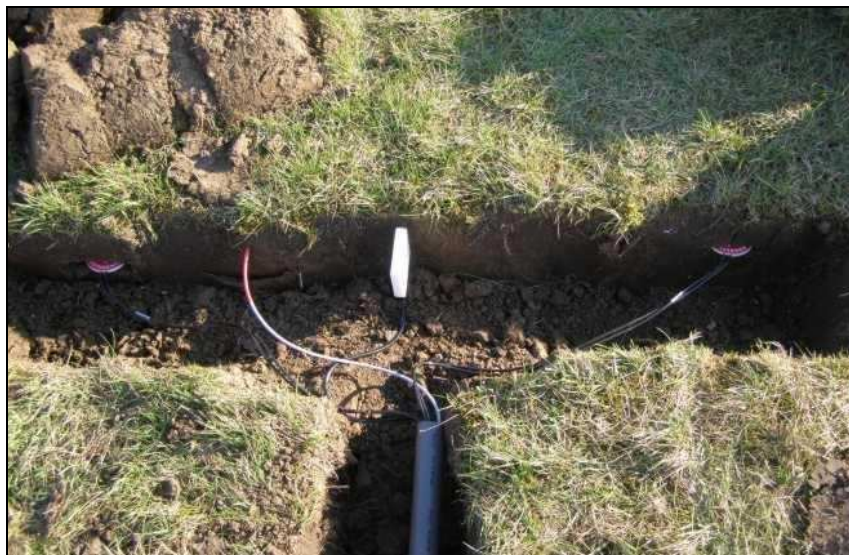
4. kép. Talajhőmérséklet, talaj hőáram és talajnedvesség mérők a felszíni energia egyenleg talaj komponensének meghatározásához
